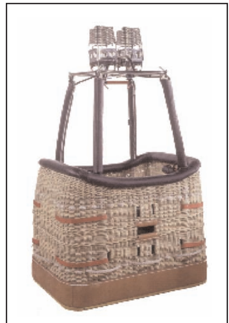
▲ Nacelle Chaize avec Brûleur Shadow double
